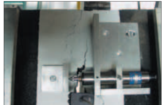
Met HaTelit ® gewapend monster: op afschuiven belast na 570.000 cycli
